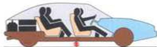
Sur les CX, grâce à la suspension hydropneumatique, la garde au sol reste constante quelle que soit la charge (dans la limite des poids autorisés).
