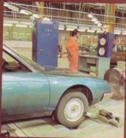
L'épreuve du banc à rouleaux - toutes les manœuvres jusqu'à une vitesse maxi de 150 km/heure.
