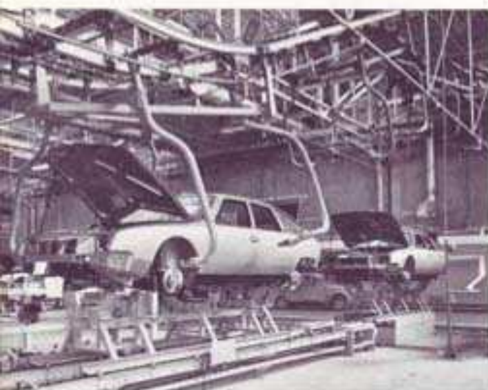
Le coffrage caisse-cadre se réalise en dynamique ; les convoyeurs ne s'arrêtent pas, ils se déplacent à la même vitesse. Deux personnes guident la manœuvre.
