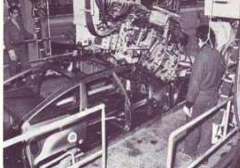
Pose de la baie de pare-brise sur une machine Languelin : 72 postes de soudure. Quelques opérations manuelles de serrage et de soudure (finition).
