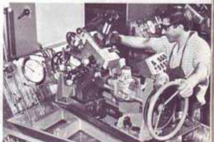
▲ Montage des petits éléments des pistons du corps de la pompe haute pression. Pièce essentielle, son rôle est de faire circuler le liquide dans les circuits en l'aspirant ou en le refoulant par ses sept pistons (selon l'équipement), tout en créant la forte pression de 175 kg/cm 2 (175 bars).
