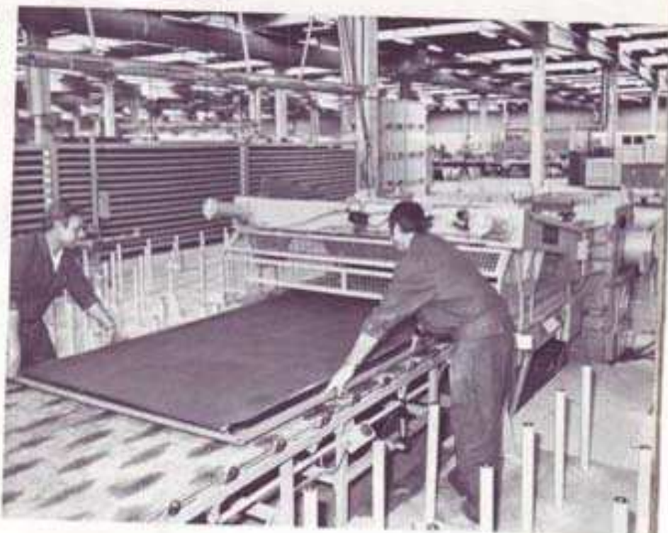
Le chariot-étaleur (20 mètres de long) est équipé d'un œil électronique qui arrête l'avancement à la longueur désirée, au millimètre près.
