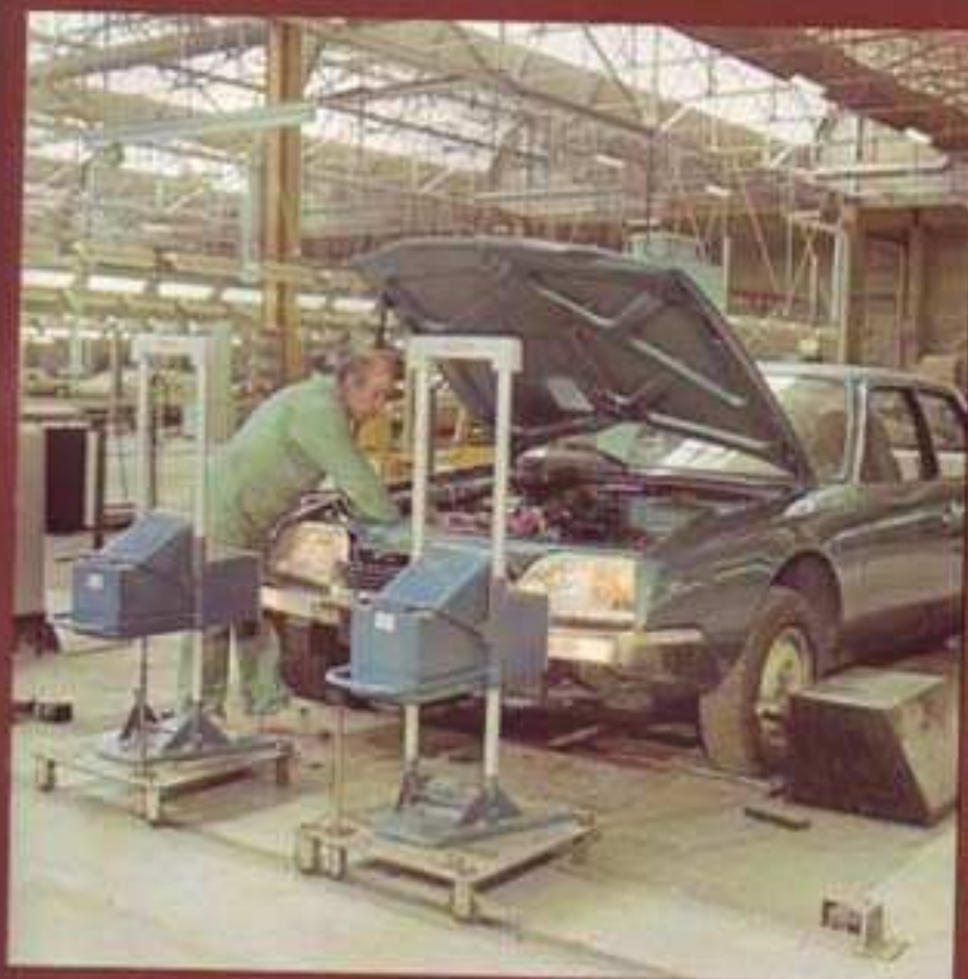
L'épreuve du banc à rouleaux - toutes les manœuvres jusqu'à une vitesse maxi de 150 km/heure.
