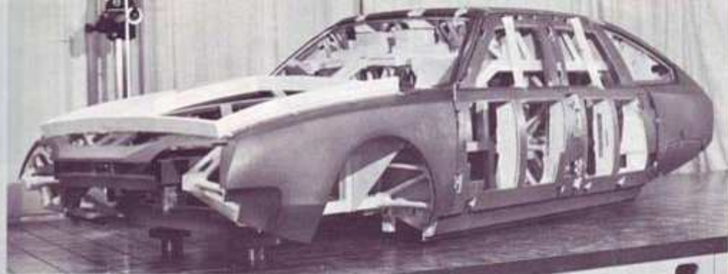
Remarquable outil de contrôle : la fausse-caisse étalon de la CX.
