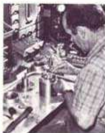
▲ Montage des petits éléments des pistons du corps de la pompe haute pression. Pièce essentielle, son rôle est de faire circuler le liquide dans les circuits en l'aspirant ou en le refoulant par ses sept pistons (selon l'équipement), tout en créant la forte pression de 175 kg/cm 2 (175 bars).
