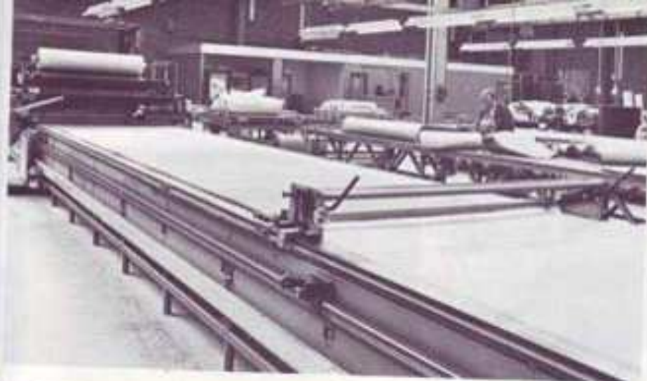
Le chariot-étaleur (20 mètres de long) est équipé d'un œil électronique qui arrête l'avancement à la longueur désirée, au millimètre près.
