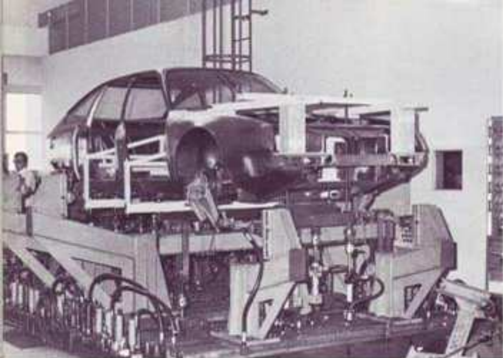
Au banc de fatigue Budd, torture sur 5 plans : avant moteur - arrière ▲ moteur - charge intérieure (passagers) - charge arrière (coffre) - freinage
