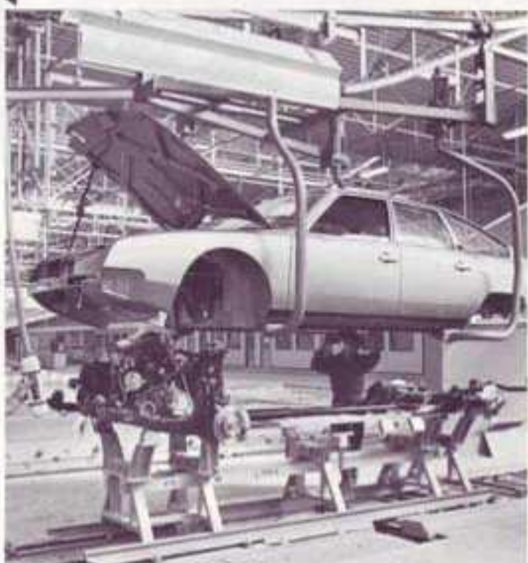
Le coffrage caisse-cadre se réalise en dynamique ; les convoyeurs ne s'arrêtent pas, ils se déplacent à la même vitesse. Deux personnes guident la manœuvre.
