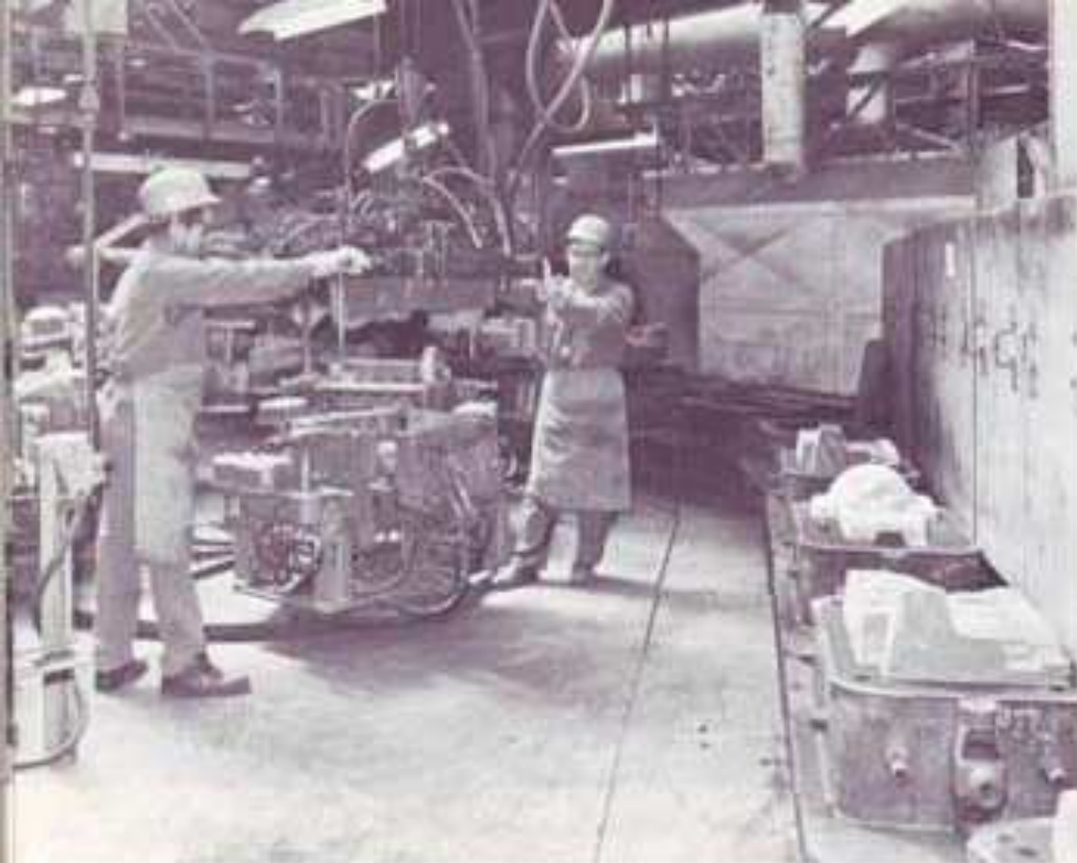
L'atelier d'assemblage et de mise en place des noyaux sur la chaîne des moules du carter-moteur. La fonte liquide s'insinuera dans les espaces laissés libres par les noyaux de sable aggloméré.
