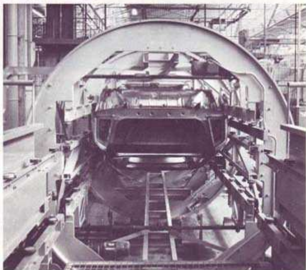
La pose des portes : un chargeur à ventouses maintient la porte pendant que l'opérateur règle et visse les charnières.
