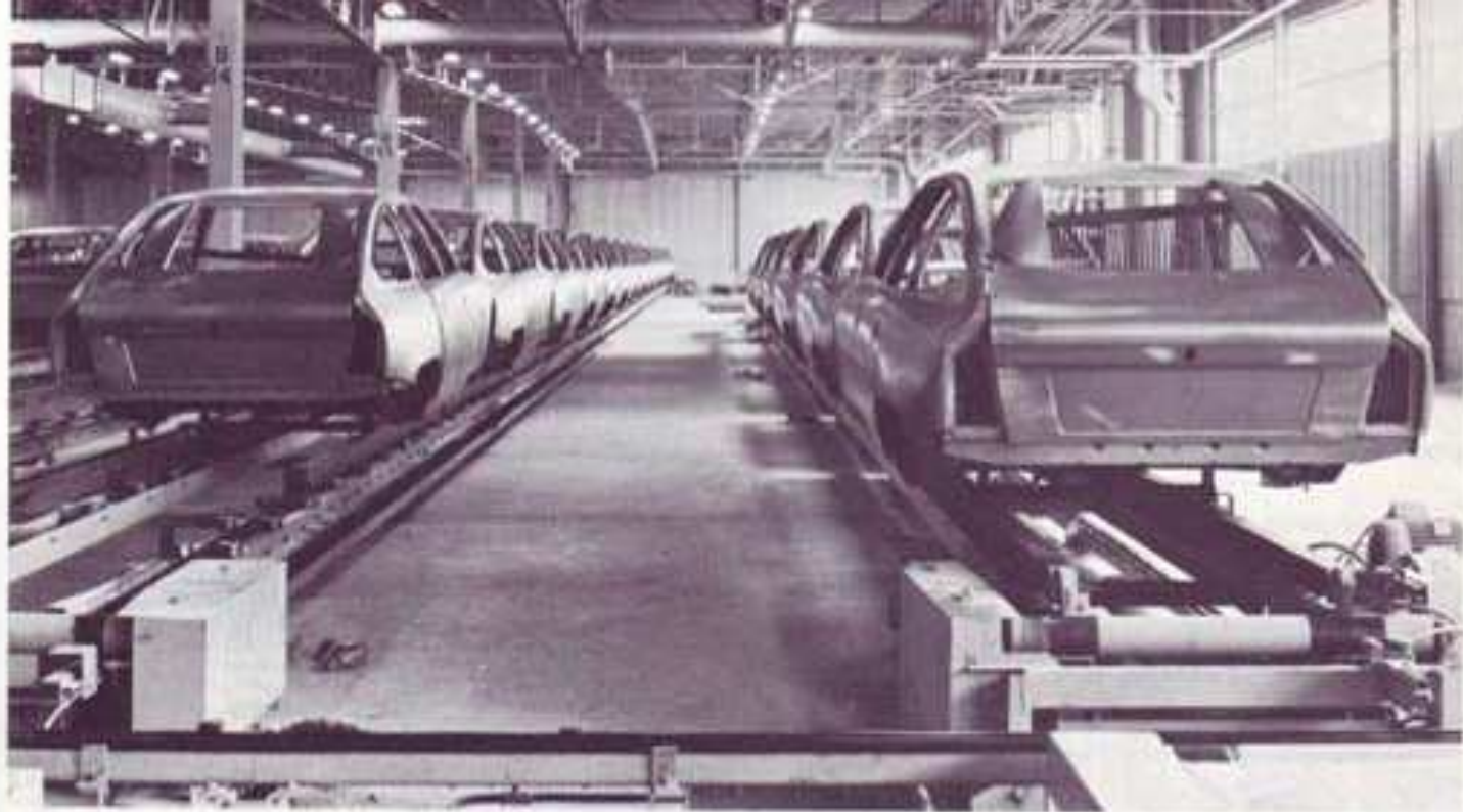
▲ La zone de tri, entre assemblage et peinture. Elle est déserte. Seul, l'ordinateur commande.
